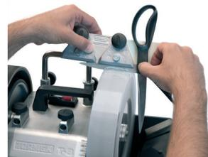
Die Scheren werden in einer Halterung montiert, die frei auf einer Stützplatte aufliegt. Der Schleifwinkel kann so eingestellt werden, dass der vorhandene Schneidenwinkel exakt reproduziert wird.
