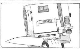
Bevor Sie Abziehen, stellen Sie sicher, dass das Abziehrad sich **von der Schneide** wegdreht, sonst wird die Schneide in das Abziehrad schneiden.
