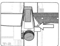
Bei Messern, wo der Griff an die Halterung stößt – lösen Sie die Halterung und bewegen Sie sie ein wenig auf der Achse, so dass die Klinge unbehindert auf die Schleifscheibe passt.
