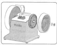
Achten Sie darauf, dass die Antriebszapfen der Abziehscheibe in die Löcher des Antriebsrades einrasten.
