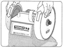
Demontieren: Halten Sie die Abziehscheibe mit einer Hand fest und drehen Sie dann die Diamant-Schleifscheibe im Uhrzeigersinn mit der anderen Hand. Die EzyLock-Mutter löst sich dadurch automatisch.
