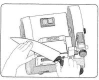
Ziehen Sie mit leichtem Druck hin und her ab. Achten Sie darauf, dass Sie einen nicht zu steilen Winkel haben, da Sie sonst die Schneide abstumpfen. Einige Male auf jede Seite ist in der Regel genug. Sie haben jetzt ein fertiggeschliffenes und scharfes Messer!
