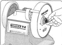
Montage: Montierend Sie die Schleifscheibe und drehen Sie die EzyLock-Mutter von Hand gegen den Uhrzeigersinn an. Bei dem ersten Schleifen zieht sich die EzyLock-Mutter automatisch mit dem korrekten Drehmoment selbst an.
