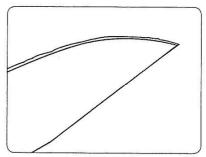
Nach dem Schliff bildet sich ein Grat oder "Bart". Dieser muss entfernt werden um eine dauerhafte Schneide zu erhalten.
