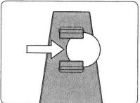
Wenn Sie das Gefühl haben, dass der Magnet Sie beim Schleifen stört, können Sie ihn ganz einfach entfernen.
