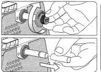
Entfernen Sie die Abstandshülse – drehen Sie die linksgängige EzyLock-Mutter von Hand im Uhrzeigersinn.
