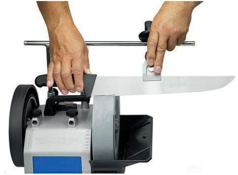
Die Stoppfunktion der SE-77 Vorrichtung für gerades Schneiden, die das Abrutschen des Werkzeugs von der Schleifscheibe verhindert, ist an der US-430 verlängerte Universalstütze nicht nutzbar, da diese dafür zu lang ist.
