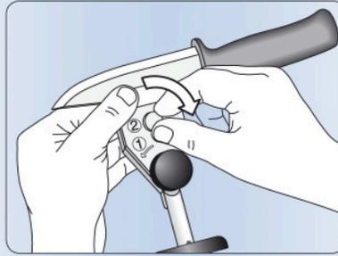
Stellen Sie die Vorrichtung mit der kleinen Schraube auf die Dicke des Messers ein.
