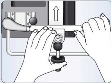
Die Vorrichtung nach unten drücken, damit sie immer in Kontakt mit der Universalstütze ist. Sehen Sie zu, dass auf der ganzen Breite des Steins geschliffen wird.
