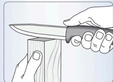
Die letzten Spuren des Grates können entfernt werden, indem man die Schneide sanft durch die Stirnseite eines Holzstückes zieht.
