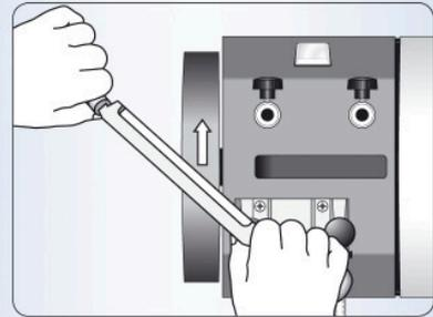
Freihändig abziehen. Das Messer diagonal führen, damit es nicht an den Stein anstößt. Beide Seiten wechselweise abziehen.
