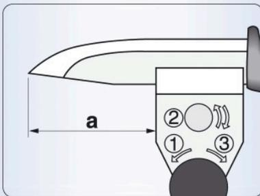
Der Schneidenwinkel der Spitze hängt davon ab, wie das Messer eingespannt wird (a). Wenn es auf den Anschlag zu eingespannt wird, vermindert sich der Schneidenwinkel der Spitze. Wenn die Vorrichtung auf die Spitze zu eingespannt wird, vergrößert sich der Schneidenwinkel der Spitze.
