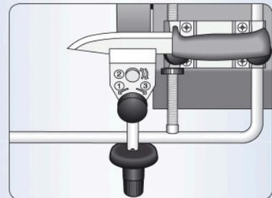
Bringen Sie die Universalstütze auf der Seite der Abziehscheibe an. Die Vorrichtung so einstellen, dass der Abziehwinkel dem Schleifwinkel entspricht.
