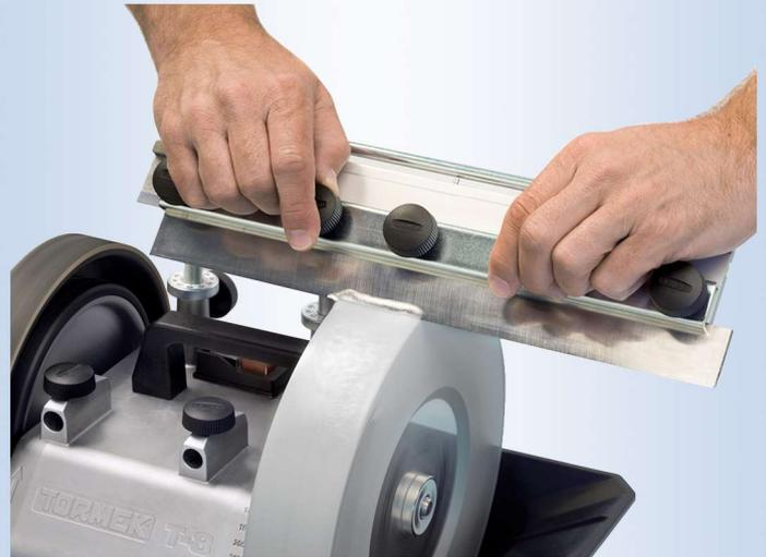
*Das Werkzeug wird präzise geführt und über seine gesamte Länge bis auf eine voreingestellte feste Tiefe flach geschliffen. Bei den anderen Tormek-Vorrichtungen ist dies nicht der Fall, da hier Ihre Hand darüber entscheidet, wo das Schleifen erfolgt und wie tief geschliffen wird. Es ist wichtig, dass der Schleifwinkel mit großer Genauigkeit eingestellt wird. Befolgen Sie die detaillierten Schritt-für-Schritt-Anleitungen sorgfältig.*
