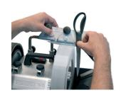
Die Scheren werden in einer Halterung montiert, die frei auf einer Stützplatte aufliegt. Der Schleifwinkel kann so eingestellt werden, dass der vorhandene Schneidenwinkel exakt reproduziert wird.
