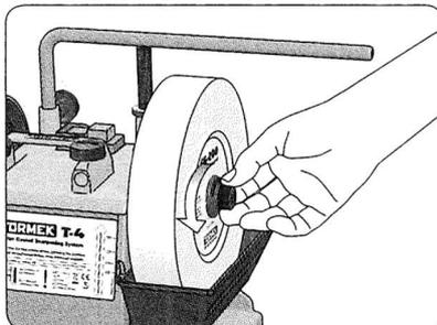
Montage: Montieren Sie den Schleifstein und die EzyLock-Mutter, indem Sie sie entgegen dem Uhrzeigersinn von Hand anziehen. Wenn Sie danach mit dem Schleifen beginnen, zieht sich die EzyLock-Mutter automatisch mit dem korrekten Drehmoment selbst an.
