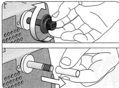
Drehen Sie die linksgängige EzyLock-Mutter von Hand im Uhrzeigersinn ab. Entfernen Sie die Abstandshülse.
