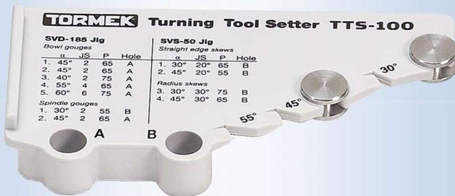
Die Einstellehre für Drehstähle TTS-100 ist der Schlüssel für ein effizientes Schleifen von Drehröhren und Schrägeisen. Sie ermöglicht die exakte Erstellung und Reproduktion des Schneidenwinkels auf Ihren Schalen- und Spindelröhren sowie auf Ihren flachen oder ovalen Schrägeisen mit gerader oder gekrümmter Schneide.
