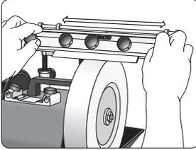
Beim Schleifen den Messerhalter mit gleichmässigen Druck zwischen den eingestellten Seitenanschlägen hin- und herführen.
