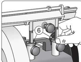
Grobeinstellung der Höhe der Vorrichtung mit Hilfe der zwei Einstellringe (6). Einstellung des Schleifwinkels mit dem Einstellknopf (7). Feineinstellung mittels der beiden Einstellringe (6). Die Schleiffase soll am Stein anliegen und der Messerhalter (2) gleichzeitig auf der Stützplatte (1) ruhen.
