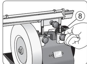
Zum Einstellen der Schleiftiefe die Ringe (6) nach oben schrauben. Beide Ringe gleichweit nach oben drehen, um Paralleleinstellung beizubehalten. Die Schleiftiefe kann an den Ringen abgelesen werden, die einen Grad pro 0,1 mm haben.
