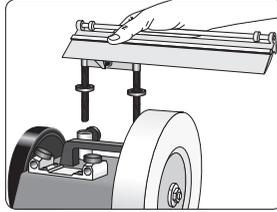
Die Universalstütze entfernen und die Stützplatte in die Hülsen der Maschine stecken. Falls erforderlich, die Abziehscheibe entfernen.
