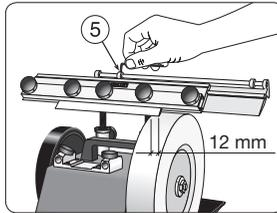
Den Messerhalter auf die Stützplatte legen. Die Länge der Schleifbewegung entsprechend der Länge des Messers einstellen, damit die Klinge während des Schleifens nicht ausserhalb der Kante des Schleifsteins landet. Das geschieht durch Feststellen der beiden Anschläge (5). Klingen länger als ca. 270 mm, werden im Halter versetzt und in zwei Schritten geschliffen.\*
