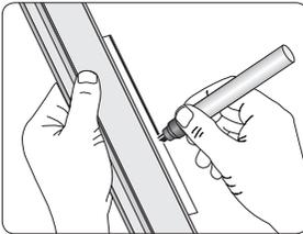
Die Schleiffase mit einem Filzschreiber einfärben, um bei der Winkeleinstellung sehen zu können, wo geschliffen wird.
