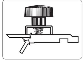
Messer in den Messerhalter einspannen. Bis zum Anschlag einschieben! Immer mit der am stärksten abgenutzten Klinge aus dem Satz beginnen.
