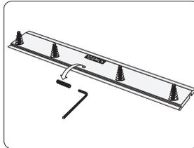
Einen 3 mm Sechskantschlüssel verwenden, um die Schrauben zu entfernen.
