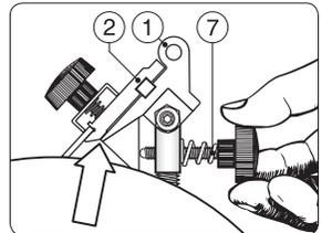
\* Sie können Klingen bis 310 mm schleifen in einem Schritt, aber stellen Sie sicher, dass Sie den Steinpräparierer SP-650 beim Schleifen anwenden, so dass der Stein flach bleibt. (Der kleine Niveauunterschied, der auf dem Stein beim Schleifen entsteht, macht es schwierig die Klinge ganz bis zu den Ecken zu schleifen.)
