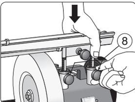
Stützplatte beim Festschrauben nach unten drücken und beide Feststellknöpfe anziehen (8).
