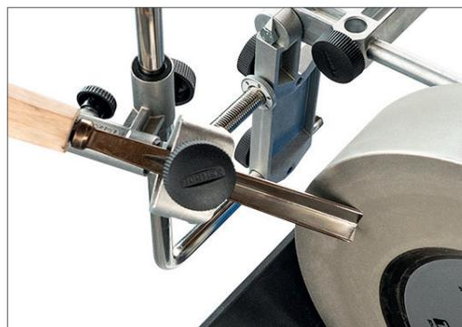
Bitte beachte, dass das Schärfen auf der Seite der Schleifscheibe mit dem MB-102 Multihalter nur bei Diamantschleifscheiben empfohlen wird. Wir empfehlen ihn nicht für das Schärfen mit Schleifsteinen, da sie verschleifen und das Abrichten erfordern, was an der Seite nicht möglich ist.
