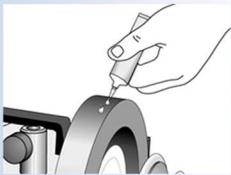
Imprägnieren Sie zuerst das Leder mit dem mitgelieferten Öl\*. Verwenden Sie ca. 2/3 der Tube für die T-8 und die Hälfte der Tube für die T-4. Dies macht das Leder weicher und lässt die Abziehpaste eindringen.
