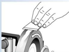
Tragen Sie eine dünne Schicht Abziehpaste auf, bevor Sie die Maschine einschalten. Die Abziehscheibe von Hand drehen.
